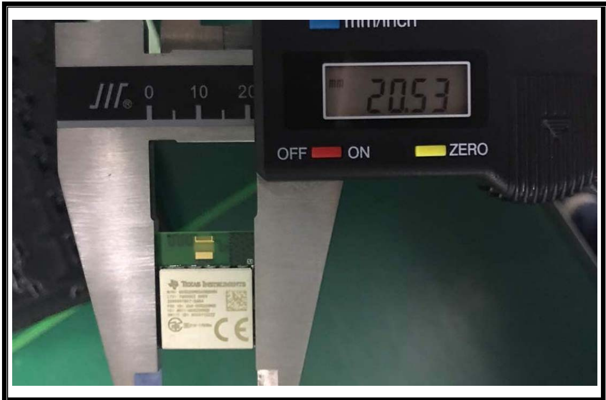
整体照 物理尺寸：长×宽×高=20.5mm (L) × 25mm (W) × 2.2mm (H)
